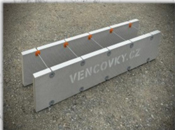
SPODNÍ TŘMENY SE NEJPRVE VOLNĚ NASUNOU DO PŘIPRAVENÝCH DRÁŽEK VE STĚNÁCH A DOTÁHNOU KŘÍDLOVOU MATICÍ, PO TĚ SE VLOŽÍ ARMOVACÍ KOŠ A NAKONEC SE PŘIPEVNÍ HORNÍ TŘMENY
